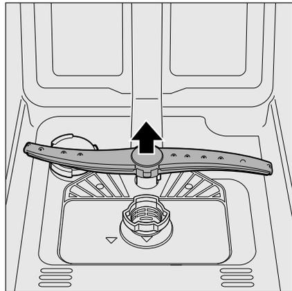
4. Sprüharme unter fließendem Wasser reinigen.
