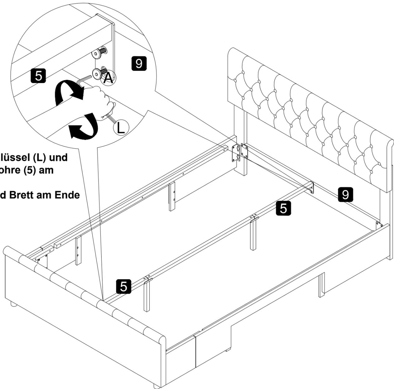
Verwenden Sie den Inbusschlüssel (L) und den Schrauben (A), um die Rohre (5) am Kopfbrettbein zu befestigen
