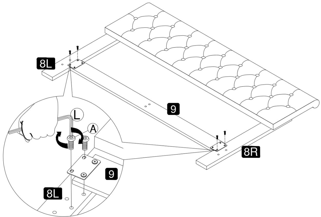
Fixieren Sie die Beinverbindungsplatte (9) am Stützfüße des Kopfbretts (8) mit Inbusschlüssel (L) Schrauben (A).
