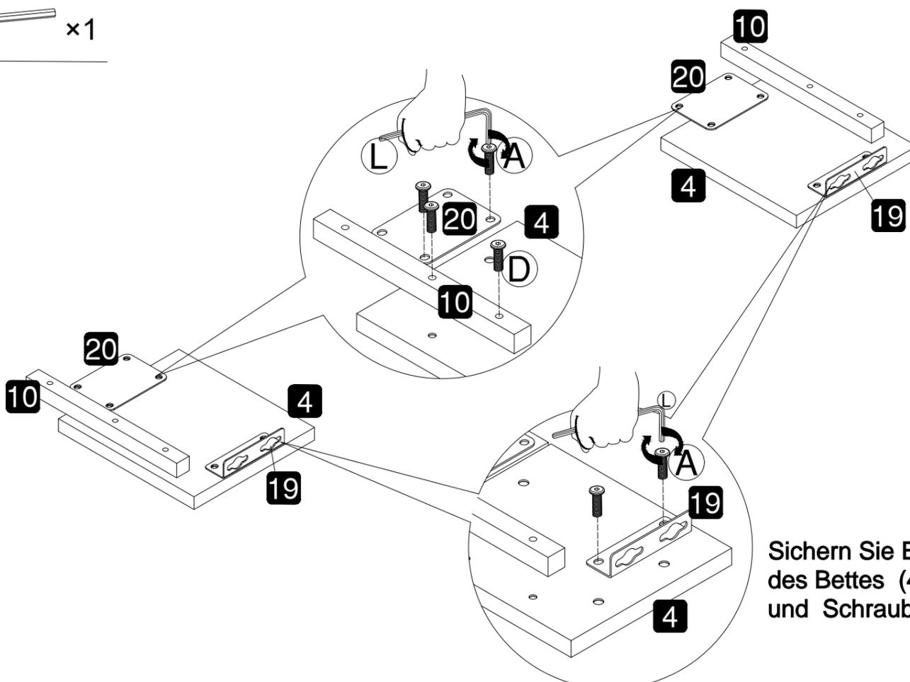
Sichern Sie Eisenblech (19) auf Seitenplatte des Bettes (4) mit einem Inbusschlüssel (L) und Schrauben (A).
