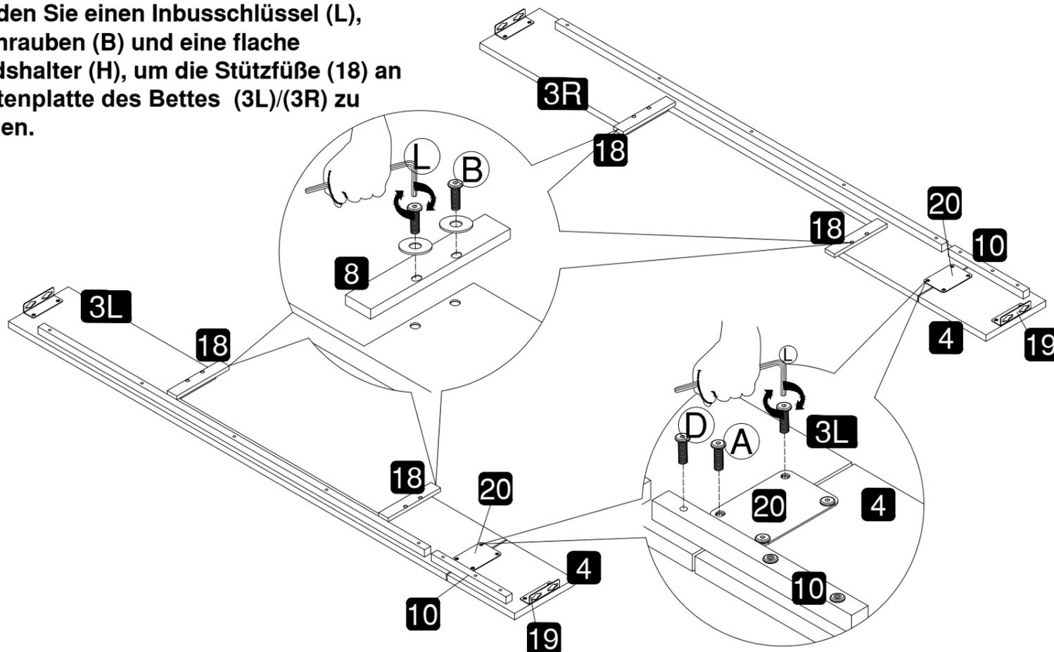
Verbinden Sie Eisenblech (20) mit Seitenplatte des Bettes (3) und Seitenplatte des Bettes (4) mit einem Inbusschlüssel (L) und Schrauben (A). Bettseitige Holzleiste (10) mit Seitenplatte des Bettes (3) und Seitenplatte des Bettes (4) mit Inbusschlüssel (L) und Schrauben (D) sichern.
