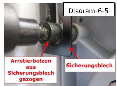
Arretierbolzen ganz aus Sicherungsblech gezogen. (6-5)
