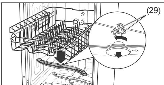
3. Der obere Sprüharm ist mit einem Bajonett-Verschluss befestigt. Zum Abnehmen des Sprüharms halten Sie die beiden gezackten Bajonettgriffe (29) fest und drehen Sie den Sprüharm im Uhrzeigersinn ab.
