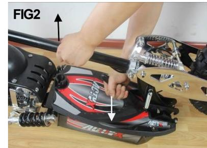
2. Um den Roller aufzuklappen halten Sie mit einer Hand am Hebel und drücken mit der anderen die Lenkstange nach oben bis diese einrastet. (FIG.2)
