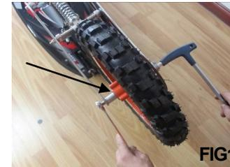
1. Nehmen Sie vorsichtig den Roller aus der Verpackung. Montieren Sie das vordere Rad. Die lange Hülse muss links und die kurze Hülse rechts vom Rad so das sich das Rad zwischen den Hülsen befindet und ziehen die Schraube fest an.(FIG.1)
