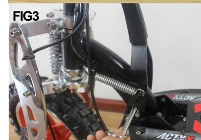
3. Überprüfen Sie ob der Klappmechanismus eingerastet ist. (FIG.3)
