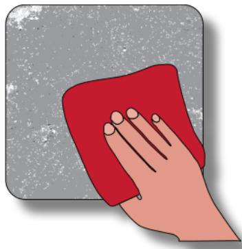
I residui di adesivo possono essere rimossi in modo efficiente per mezzo di un solvente per silicone o di benzina per smacchiare.
