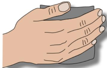
Continuare a staccare lentamente la pellicola protettiva e allo stesso tempo premere o arrotolare il nastro adesivo antiscivolo più volte in senso longitudinale e trasversale con un rullo di pressione, ad esempio in direzione degli angoli e dei bordi.
