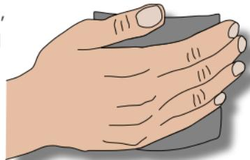
Schutzfolie langsam weiter abziehen und das Antirutsch Klebeband gleichzeitig mit einer z.B. Andruckrolle langsam in Richtung auf die Ecken und Kanten längs und quer mehrmals kräftig andrücken bzw. anrollen.
