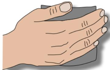
Continuer à retirer lentement le film de protection et presser ou rouler en même temps le ruban adhésif antidérapant avec un rouleau de pression, par exemple, en direction des coins et des bords, plusieurs fois en longueur et en largeur.
