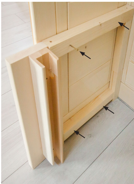
Fig. 18: Montar os apoios do banco
