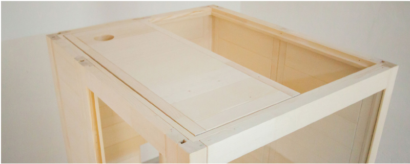
Abb. 14: Einlegen Dachelemente vorne
