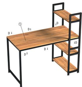
**5** Bitte befestigen Sie zwei Bretter ④ wie in Schritt 5 gezeigt, achten Sie darauf, dass die Richtung der Tischfüße auf dem ⑤ mit dem ④ übereinstimmt.
