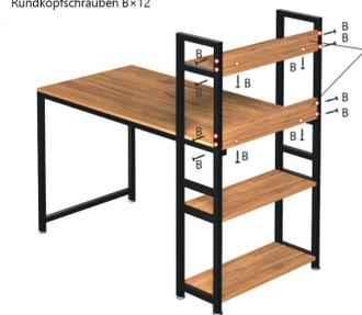
**6** Bringen Sie die Stangen ⑧ wie in Schritt 6 gezeigt an und drehen Sie dann die Schrauben der Tischfüße, um den Computertisch waagrecht zu stellen.
