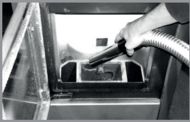
Abb. 12d: Reinigung der Topfhalterung
