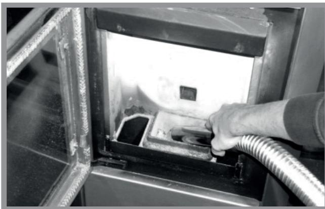
2. Entnehmen Sie dann den Brenntopf. Überprüfen Sie die Luftöffnungen am Boden des Brenntopfes. Vergewissern Sie sich, dass alle Luftöffnungen weder verstopft noch zugesetzt sind. Saugen Sie den Brenntopf gründlich ab (siehe Abb. 12b). Entfernen Sie hartnäckige Verkrustungen und Blockaden, wenn nötig, mit einem geeigneten Werkzeug (siehe Abb. 12c).
