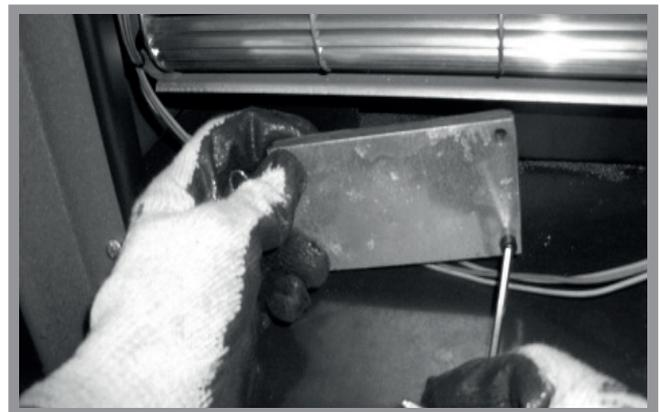
Abb. 13b: Aufschrauben der inneren Abdeckplatte
