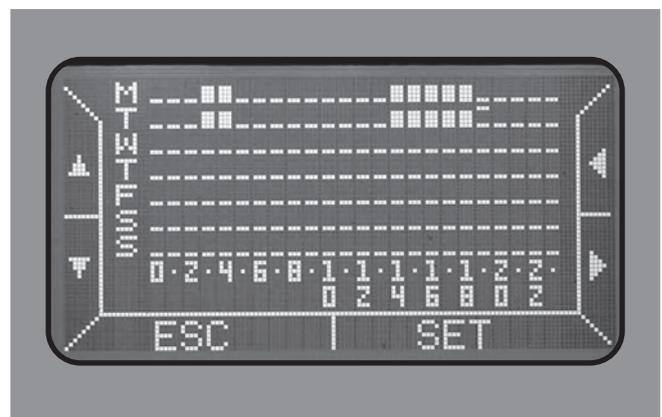
Abb. 9b: Display-Anzeige SET TIMER, programmiert
