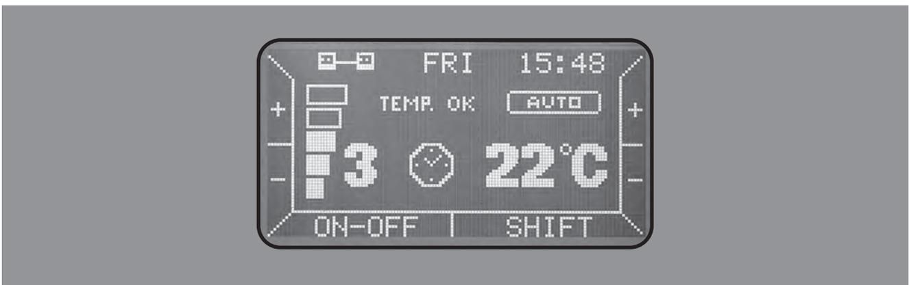
Abb. 11: Display-Anzeige bei Automatikbetrieb
