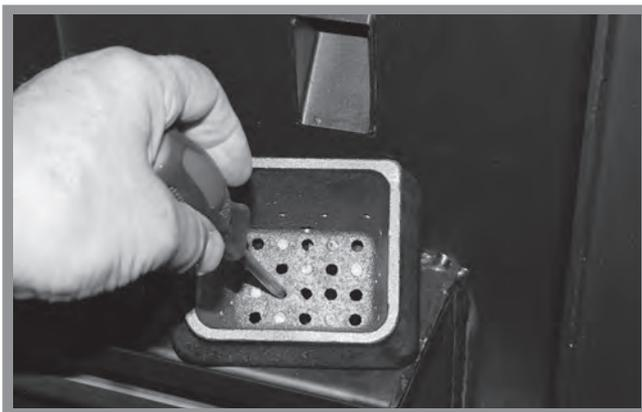
Abb. 12c: Reinigung der Luftöffnungen mit einem Werkzeug
