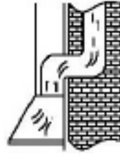
2 Sortie d'air par un puits d'aération
