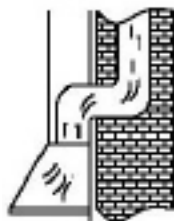
2 Uscita dell'aria tramite un sistema di ventilazione
