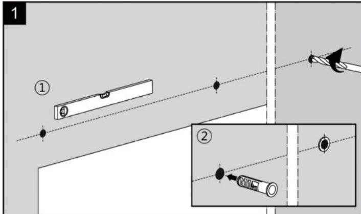
Bohrlöcher gemäß Höhe H1 anzeichnen und bohren
