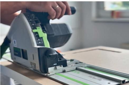
2. Schneiden Sie zunächst die langen Schnitte mit einer Tauchsäge (eventuell auch mit einer Stichsäge). Anschließend schneiden Sie vorsichtig die Ecken mit einer Stichsäge aus.
