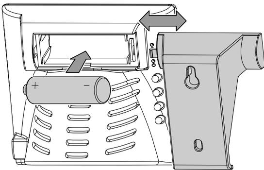
3. Schließen Sie das Batteriefach, indem Sie den Bügel in entgegengesetzter Richtung über das Batteriefach schieben.
