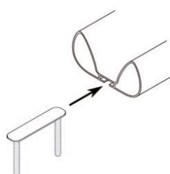
Procedere allo stesso modo dall'altro lato della piastra di base. Posizionare il portabici parallelamente all'asse longitudinale del veicolo. A bicicletta montata, assicurarsi che non vi siano parti della bicicletta che sporgano dal perimetro esterno del veicolo. A questo punto, stringere tutte le viti e i dadi.
