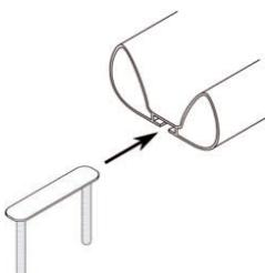
Setzen Sie eine Gurtführung in die T-Nut an dem Ende (der längere Teil von der Grundplatte aus) der Radschiene ein, wo später das Hinterrad des Fahrrades befestigt wird. An dem anderen Ende (der kürzere Teil von der Grundplatte aus) setzen Sie die beiden anderen Gurtführungen für die Befestigung des Vorderrades ein.
