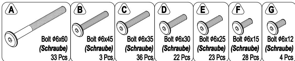
Bitte beachten Sie, dass die Formen der Schrauben A, B, C, D, E, F und G ähnlich sind. Bitte installieren Sie entsprechend der Anleitung und unterscheiden Sie sie!
