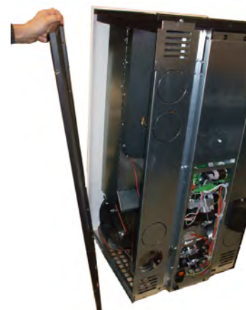
Fig. 63 - Abnehmen der Seitenwand
