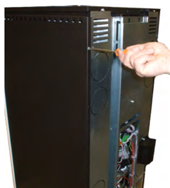
Fig. 62 - Lösen der hinteren Schraube
