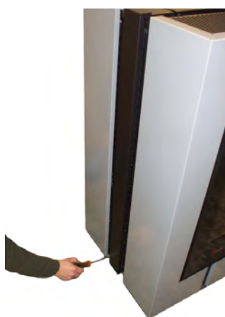
Fig. 64 - Lösen der unteren Schrauben
