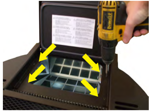
Fig. 68 - Lösen der Schrauben des Deckels 2
