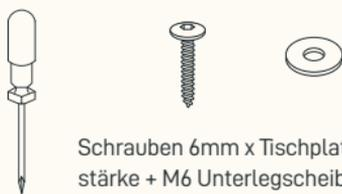
Schrauben 6mm x Tischplattenstärke + M6 Unterlegscheiben
