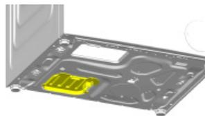
Kippen Sie die Maschine leicht nach hinten. Legen Sie die Laschen von Abdeckung A gegen die untere Platte. Schließen Sie die Montage ab, indem Sie die Abdeckung drehen.
