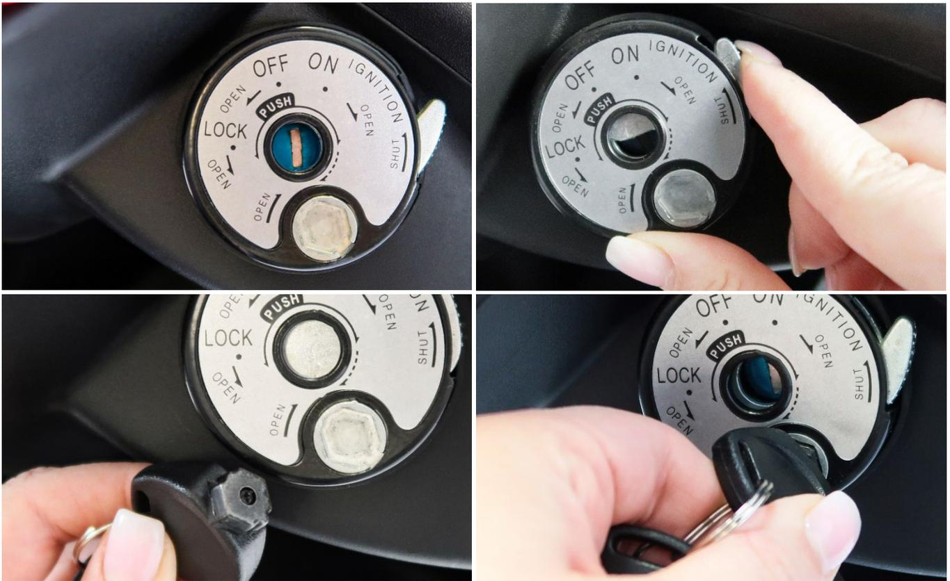
Mit dem Zündschlüssel können Sie den MAXIMUS MX2-45 ein-/ausschalten. Zusätzlich können Sie mit dem Schlüssel das Lenkradschloss aktivieren und den Lenker sperren. Der Schlüssel dient auch zum Öffnen und Schließen der Sitzbank (siehe Seite 23).
