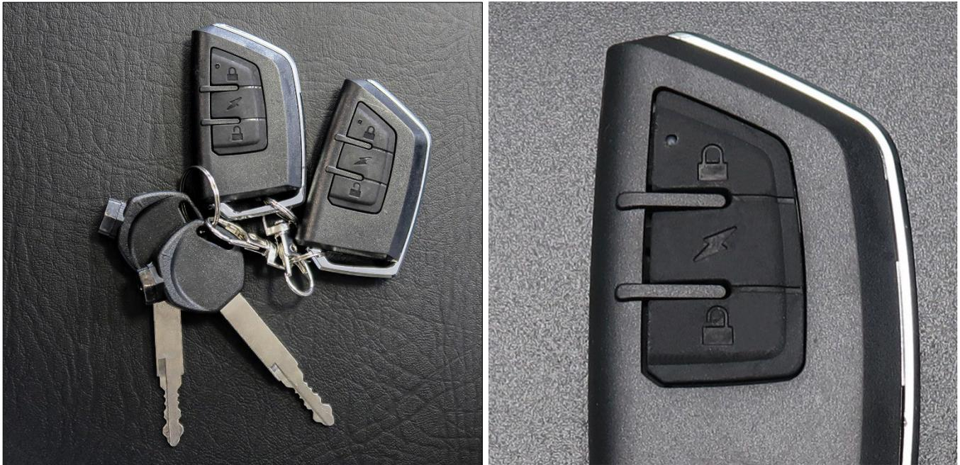
Mit der oberen Taste (**geschlossenes Schloss-Symbol**) schalten Sie die Alarmanlage ein. Sie hören einen Signalton.
