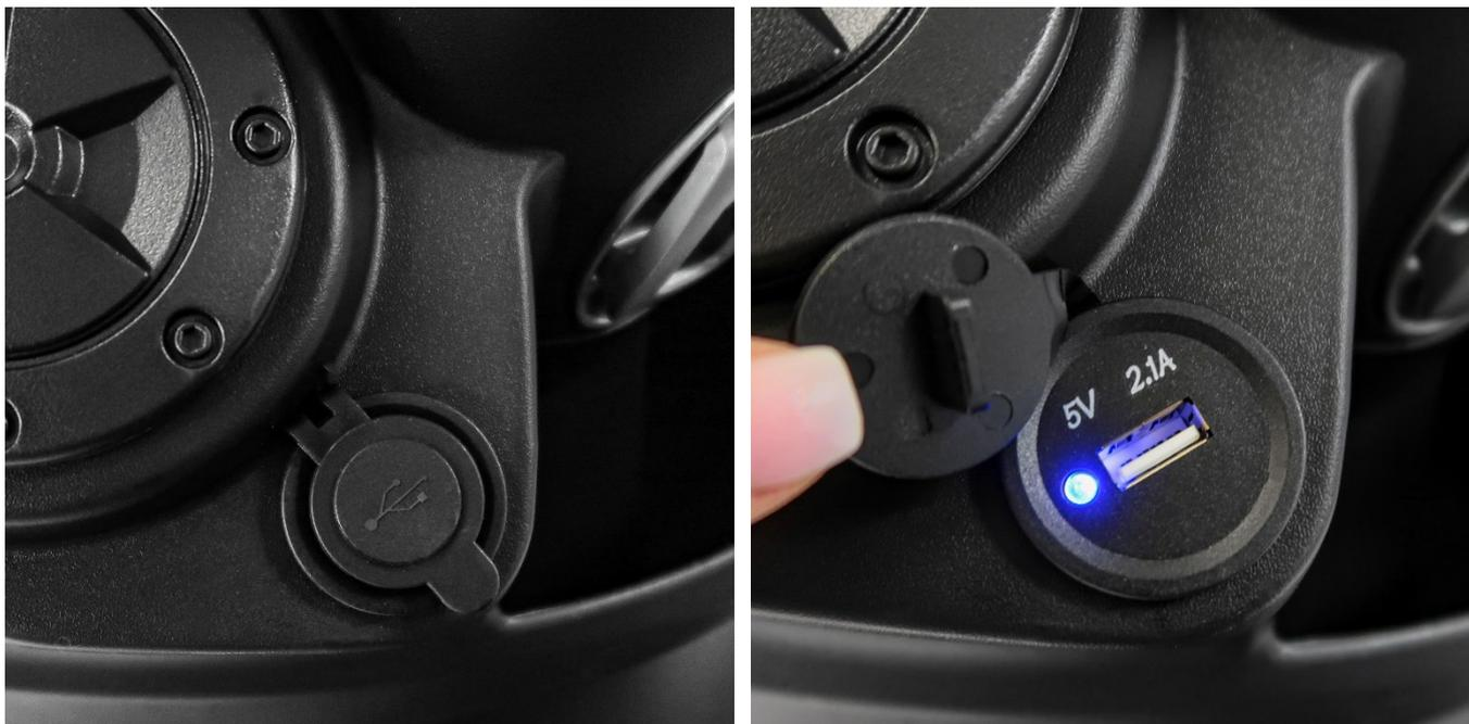
Die USB-Ladebuchse befindet sich an der vorderen Konsole links zwischen der Getränk-Halterung und dem Ablagefach. Die Ladebuchse verfügt über einen spritzwasser-geschützten Deckel.
