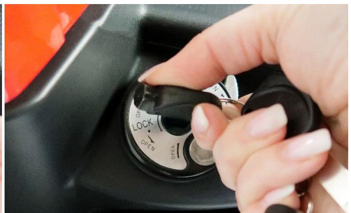
Drehen Sie den Schlüssel (OFF Stellung) in Richtung Lock Position, ohne den Schlüssel dabei zu drücken.
