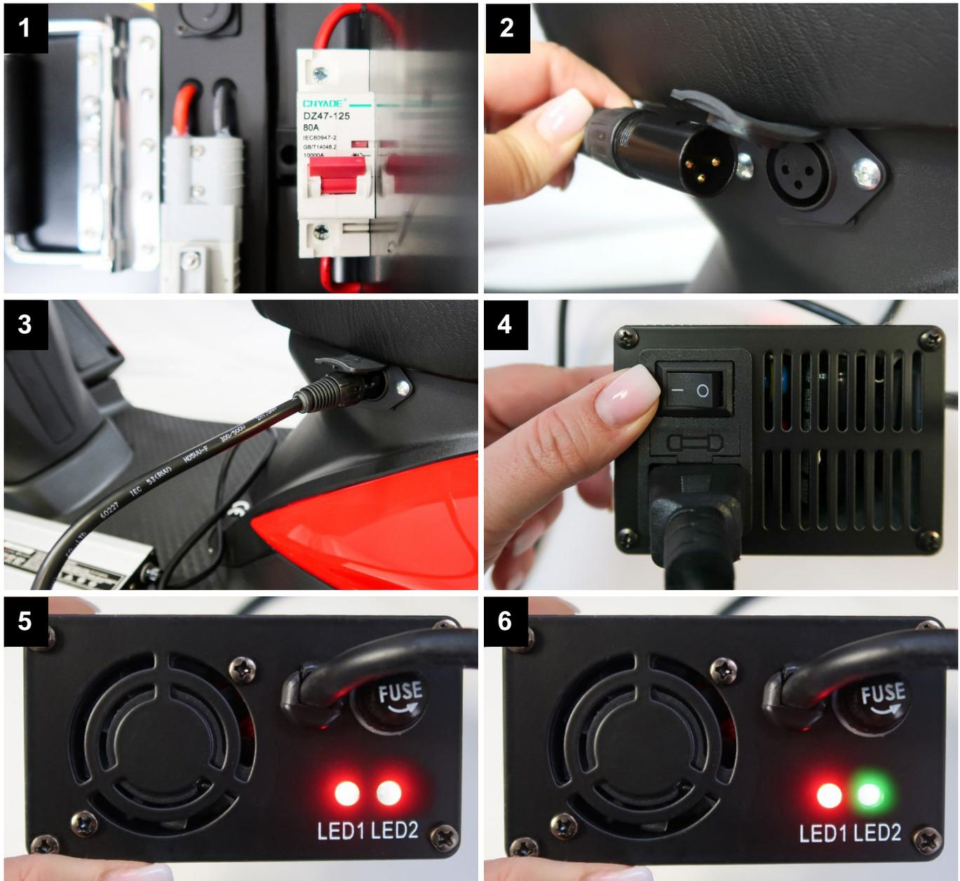
Laden Sie den MAXIMUS MX2-45 über die Ladebuchse, die sich seitlich unter der Sitzbank befindet.
