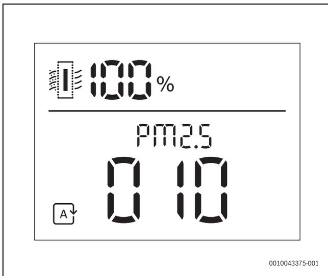
Bild 48 Filterlebensdauer bei 100 %
