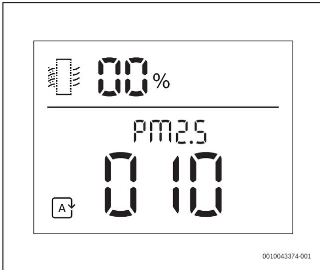
Bild 47 Filterlebensdauer bei 0 %
