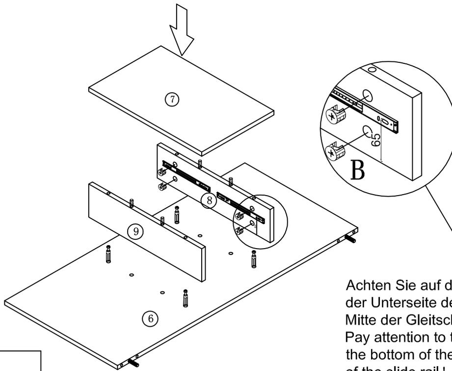
Achten Sie auf den Abstand zwischen der Unterseite der Platine und der Mitte der Gleitschiene!
