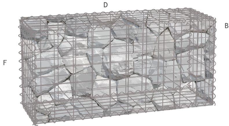
NACHDEM DIE GABIONE AUFGEFÜLLT WURDE, BEFESTIGEN SIE DIE ANDERE GITTERPLATTE (B) ALS DECKEL DURCH DIE SPIRALEN (D, F) AN DER OBERSEITE DES HAUPTTEILS DER GABIONE.
