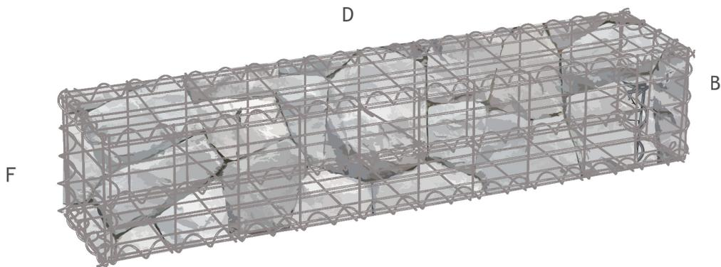
NACHDEM DIE GABIONE AUFGEFÜLLT WURDE, BEFESTIGEN SIE DIE ANDERE GITTERPLATTE (B) ALS DECKEL DURCH DIE SPIRALEN (D, F) AN DER OBERSEITE DES HAUPTTEILS DER GABIONE.
