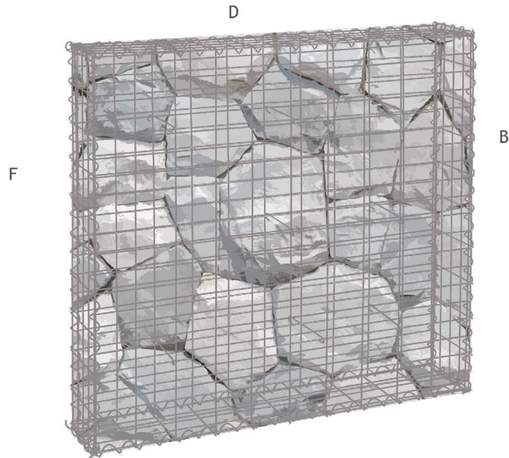
NACHDEM DIE GABIONE AUFGEFÜLLT WURDE, BEFESTIGEN SIE DIE ANDERE GITTERPLATTE (B) ALS DECKELDURCH DIE SPIRALEN (D, F) AN DER OBERSEITE DES HAUPTTEILS DER GABIONE.
