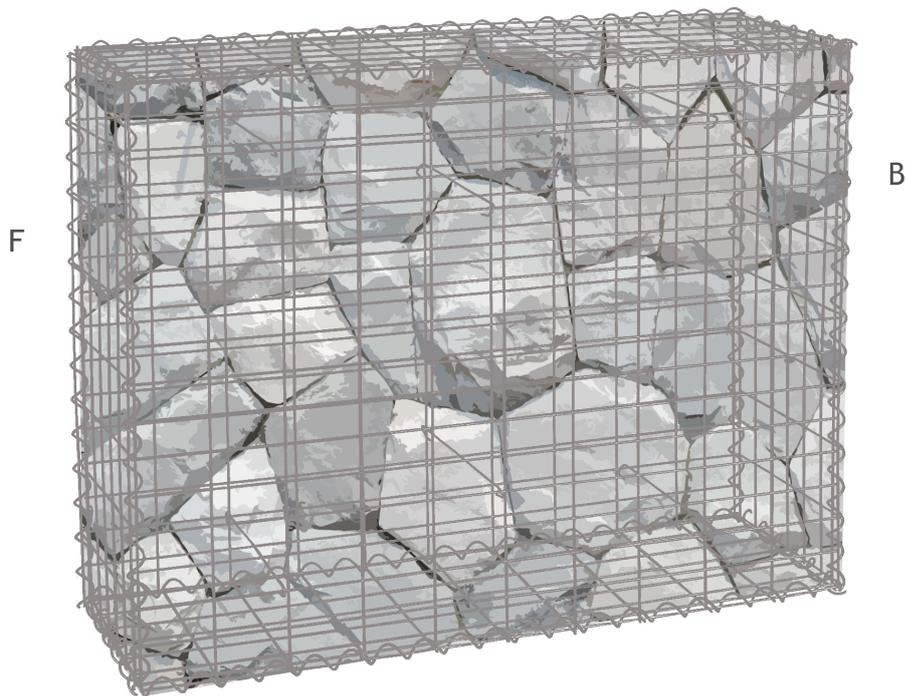
NACHDEM DIE GABIONE AUFGEFÜLLT WURDE, BEFESTIGEN SIE DIE ANDERE GITTERPLATTE (B) ALS DECKEL DURCH DIE SPIRALEN (D, F) AN DER OBERSEITE DES HAUPTTEILS DER GABIONE.
