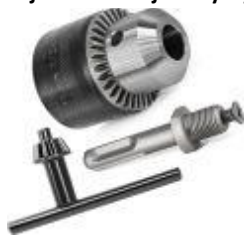
215.013.001 — Uchwyt wiertarski S&R 1,5-13 mm 1/2-20 UNF z adapterem SDS-plus.
