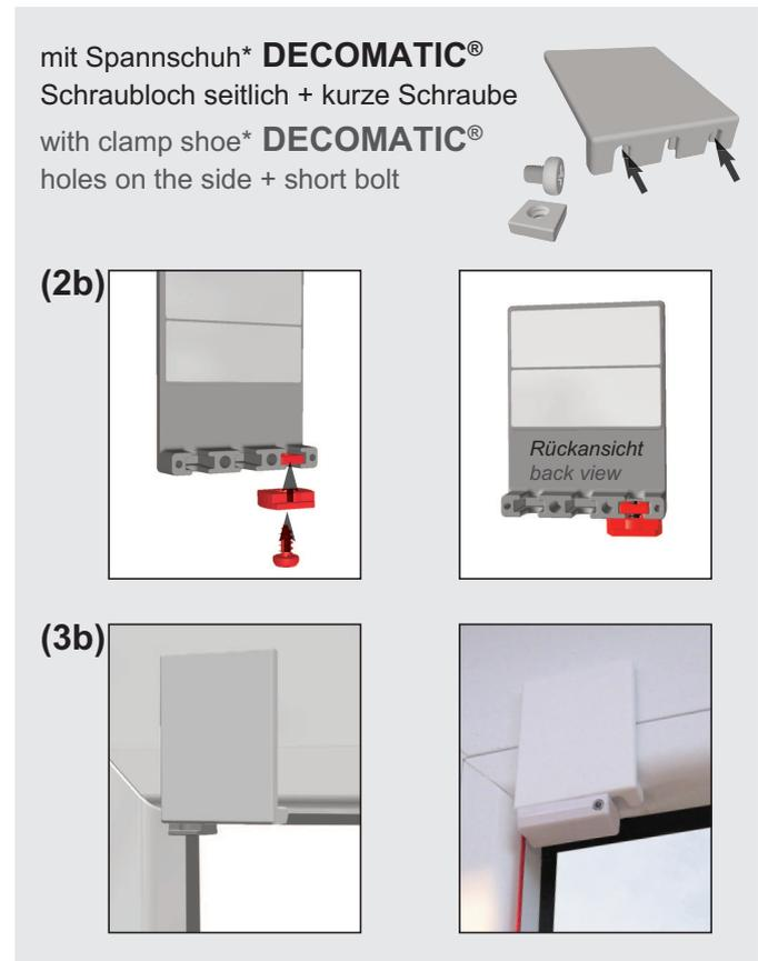
(2) Schraubenmutter je nach Plisseeanlage an entsprechender Position einlegen und das Spannschuh\*-Unterteil montieren (rechts u. links beachten). Bitte die Schraube nicht zu fest anziehen, da der Klebeträger sonst beschädigt werden kann !
