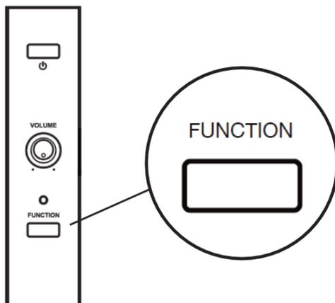
Halten Sie die Funktionstaste gedrückt, um die Funktionsbelegung der Klaviertasten anzusteuern.
