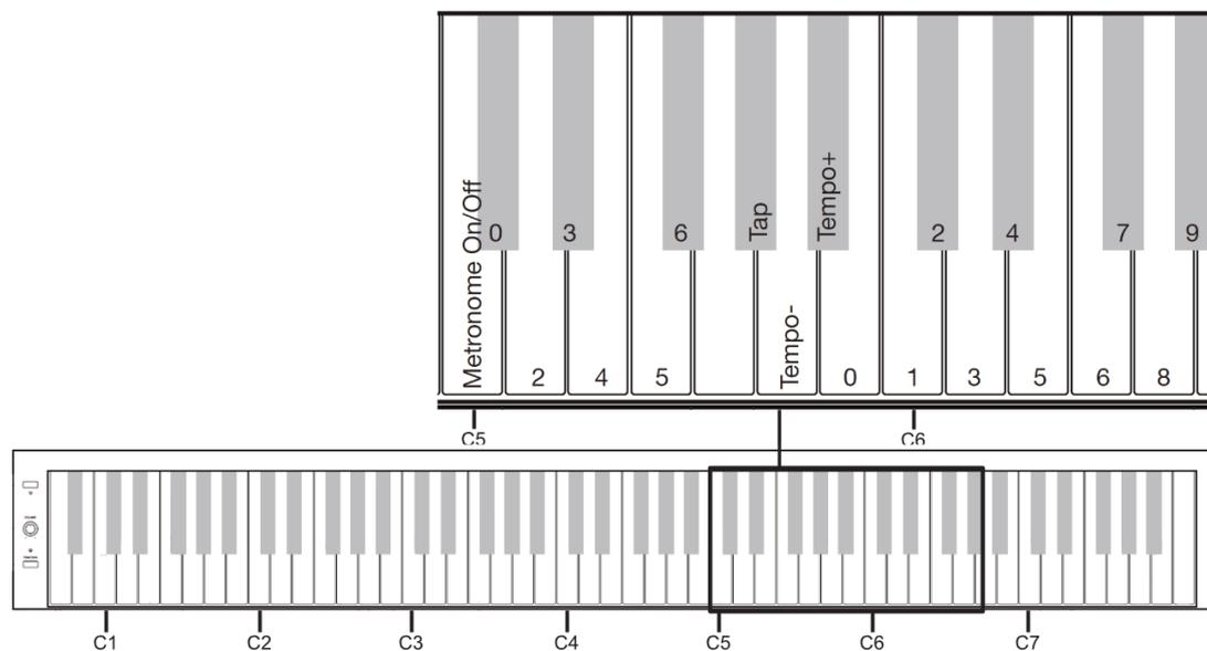
Halten Sie die Funktionstaste gedrückt und drücken Sie die Taste METRONOME ON/OFF, um das Metronom zu aktivieren bzw. zu deaktivieren. Bei aktiver Metronom Wiedergabe können Sie das Taktmaß ändern, indem Sie die Funktionstaste gedrückt halten und das gewünschte Taktmaß (0-6) auswählen. Hierbei steht 3 z.B. für einen  $\frac{3}{4}$  Takt und 4 für einen  $\frac{4}{4}$  Takt. Wählen Sie die 0, um alle Metronomschläge mit gleicher Gewichtung wiederzugeben.
