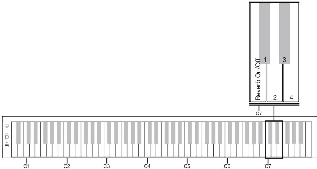
Um dem Raumklang des Pianos aufzuwerten, besitzt das Instrument eine Hall-Funktion. Drücken Sie bei gehaltener Funktionstaste die Taste REVERB ON/OFF, um den Hall-Effekt zu deaktivieren bzw. wieder zu aktivieren. Bei aktiviertem Hall-Effekt stehen vier unterschiedliche Effekt Typen zur Auswahl. Drücken Sie zur Auswahl bei gehaltener Funktionstaste eine der Reverb 1-4 Tasten (1=Room, 2=Hall1, 3=Hall2, 4=Church).
