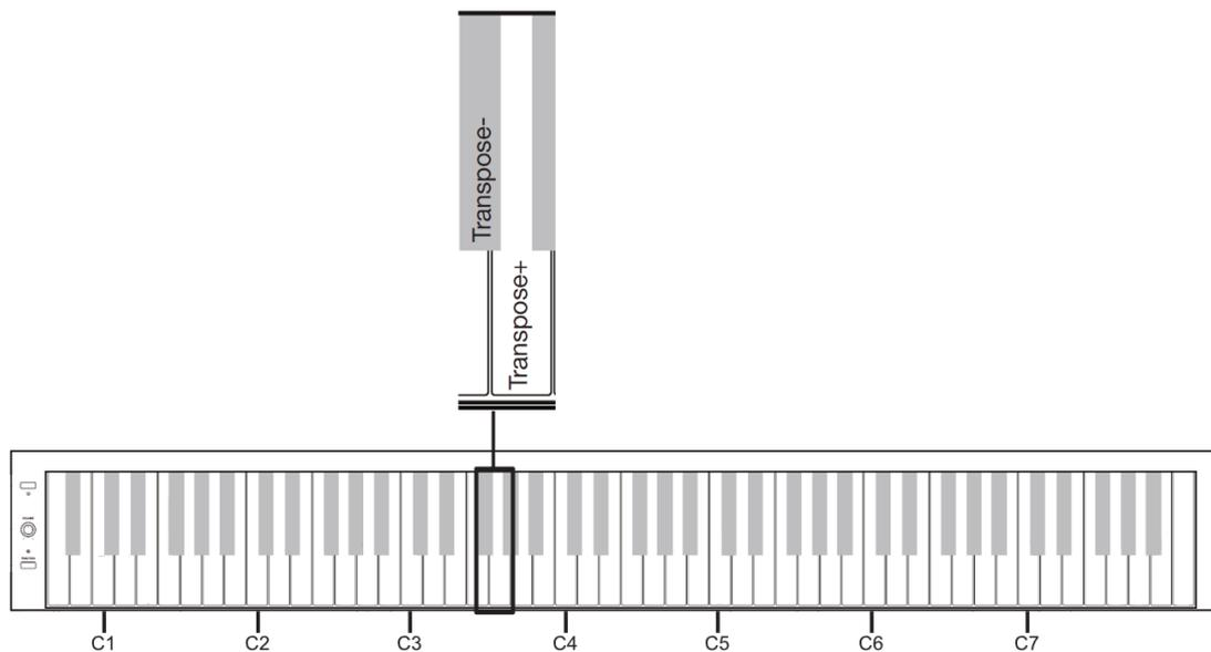
Mit der Transpose Funktion kann die Tonhöhe des Instruments in Halbtonschritten nach unten oder oben verändert werden.
