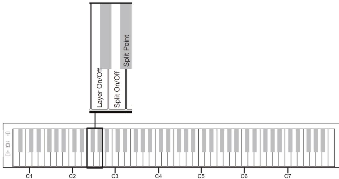
Mit der Layer-Funktion können zwei Klangfarben kombiniert und übereinandergelegt werden. Wählen Sie zuerst, wie im Punkt **Voice** beschrieben die erste der beiden gewünschten Klangfarben aus. Drücken Sie nun bei gehaltener Funktionstaste die LAYER ON/OFF Taste, um die Layer Funktion zu aktivieren. Nun können Sie wie im Punkt **Voice** beschrieben die zweite Klangfarbe auswählen.
