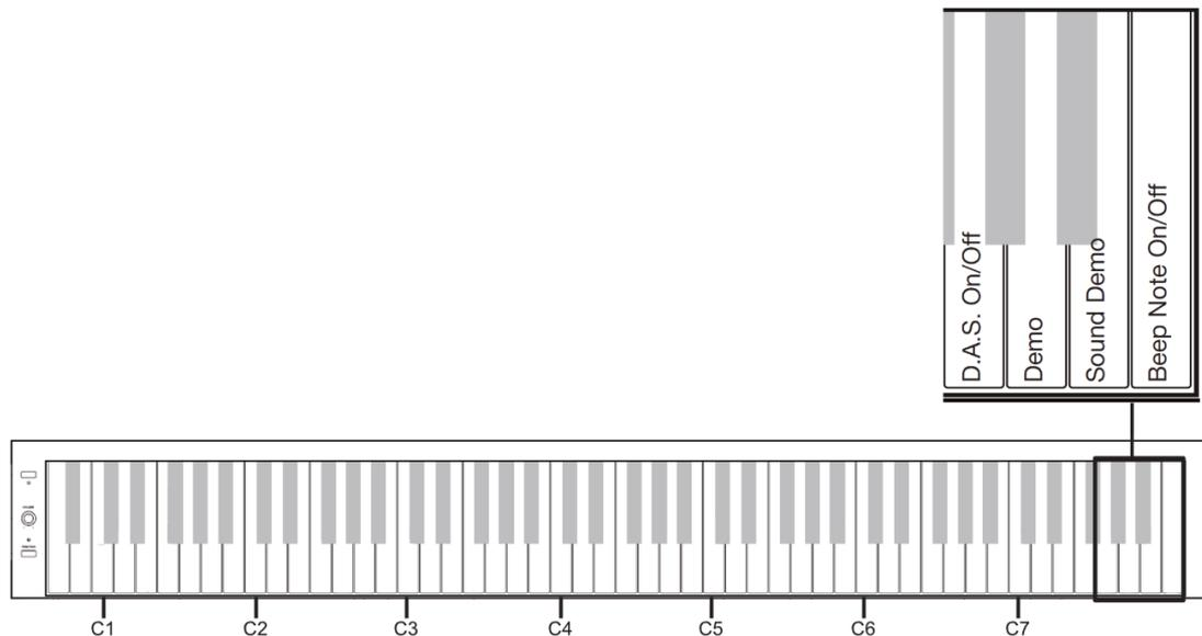
Die D.A.S. Funktion (Dynamically adjusted sound) past den Dynamikumfang optimal der gewählten Lautstärkeeinstellung an, um psychoakustisch jederzeit den maximalen Dynamikumfang zur Verfügung zu stellen. Drücken Sie bei gehaltener Funktionstaste die Taste D.A.S. ON/OFF, um diese Funktion zu deaktivieren oder wieder zu aktivieren.
