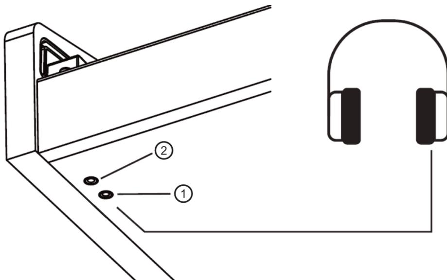
Die beiden Kopfhöreranschlüsse an der linken Unterseite des Spieltisches können gleichzeitig genutzt werden. Beim Anschluss eines Kopfhörers an die Kopfhörerbuchse 1 werden die Lautsprecher des Instruments deaktiviert. Beim Anschluss an die Kopfhörerbuchse 2 wird der Klang des Instruments über die Kopfhörer und zusätzlich weiterhin über die Lautsprecher wiedergegeben.
