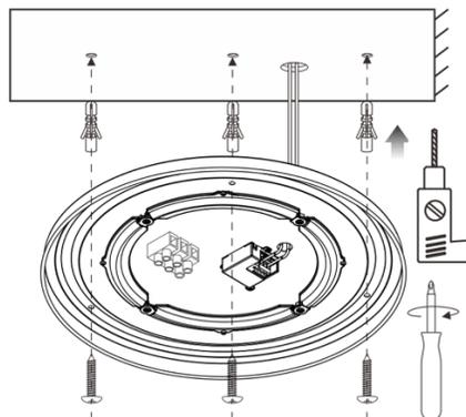
3. Schließen Sie die Kabel L/N/E richtig an.
