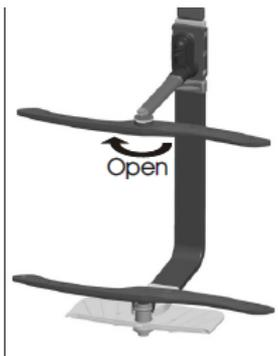
Die Sprüharme müssen regelmäßig von Kalkablagerungen befreit werden, sonst könnten die Düsen und Lager der Sprüharme verstopfen. Zum Entfernen des Sprüharms, die Mutter nach rechts drehen, um die Unterlegscheibe auf dem Arm herauszunehmen und dann den Sprüharm selbst entfernen. Die Arme in warmem Seifenwasser reinigen und mit einer weichen Bürste die Düsen säubern. Danach alles gut unter laufendem Wasser abspülen.
