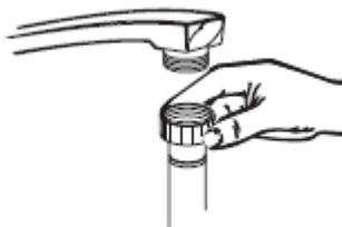
Verbinden Sie den Wasserzufuhrschlauch mit einem  $\frac{3}{4}$ " Gewindeanschluss und ziehen Sie das ganze gut fest.
