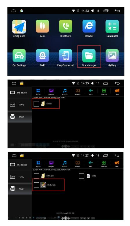
Wenn ES File Browser im Fahrzeug installiert ist und einen externen USB-Stick auswählt, wird die APK-Installationssoftware, uCardvr.apk, angezeigt:
