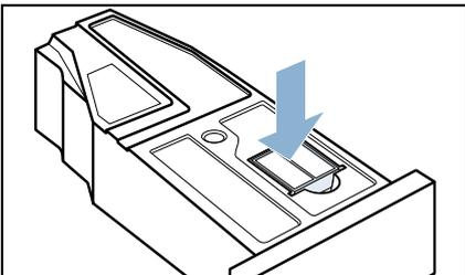
12. Den Kondenswasser-Behälter bis zum Einrasten einschieben.
