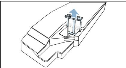
11. Den Filter in die Vertiefung des Kondenswasser-Behälters setzen.
