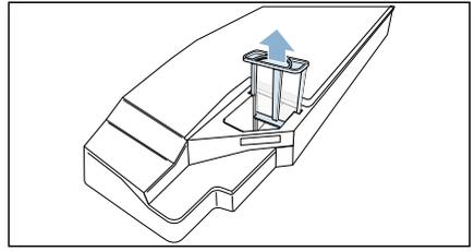
4. Sieb unter fließendem warmen Wasser oder in der Geschirrspülmaschine reinigen.
