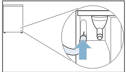
5. Ablaufschlauch aus dem Zubehör nehmen und am freiliegenden Stutzen befestigen und bis zum Anschlag schieben.
