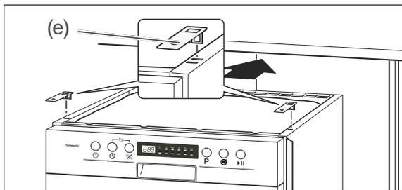
4. Stecken Sie beide Montagewinkel (e) in die vorderen Schlitze an der oberen Seite des Geschirrspülers, um später den Geschirrspüler an die Arbeitsplatte anschrauben zu können.
