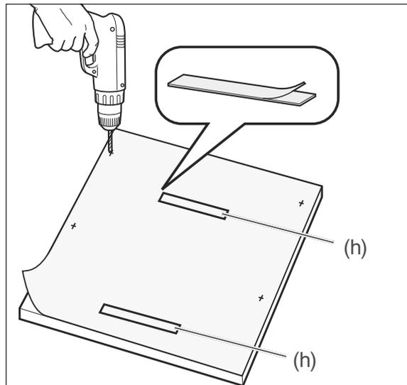
12. Legen Sie die mitgelieferte Bohrschablone so auf die **Rückseite** der Möbelfrontplatte, dass die Bohrschablone und die Möbelfrontplatte oben bündig abschließen.
