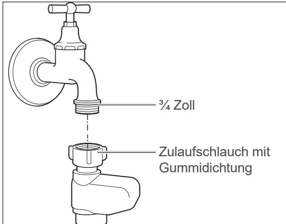
Für die Wasserversorgung benötigen Sie einen Wasserhahn mit einem  $\frac{3}{4}$  Zoll Schraubanschluss.
