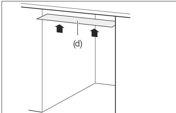
3. Kleben Sie die beiliegenden Schutzfolie für Kondenswasser (d) auf die Unterseite der Arbeitsplatte. So vermeiden Sie Schäden an der Arbeitsplatte aufgrund heißer Dämpfe, die bei geöffneter Tür aus dem Geschirrspüler strömen.
