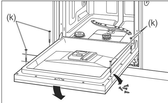
17. Entfernen Sie die 4 Schrauben an der Innenseite der Tür. Schrauben Sie die Möbelfrontplatte an diesen Positionen mithilfe der beiliegenden 4 Schrauben (k) fest.
