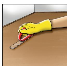
3. Klebeband mit der klebenden Fläche nach unten auflegen und fest andrücken, danach die rote Schutzfolie abziehen.
