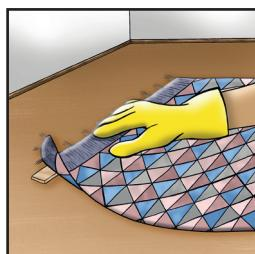
4. Colocar las partes a unir exactamente una encima de la otra y presionar las juntas durante algún tiempo para asegurar una sujeción óptima.
