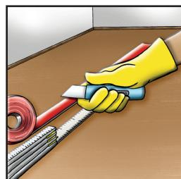
2. Klebeband abmessen und auf die gewünschte Länge zurechtschneiden.
