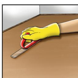
3. Colocar la cinta con el lado adhesivo hacia abajo en la zona a adherir y presionar firmemente, luego retirar la lámina protectora roja.
