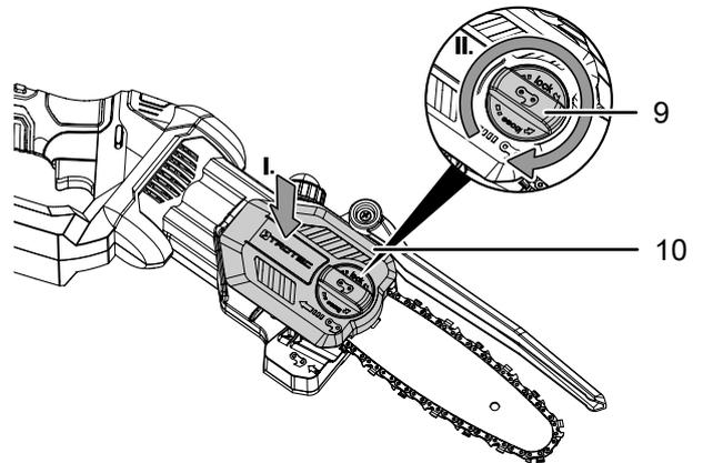
5. Legen Sie die neue Sägekette (7) in die Führungsschiene. Achten Sie auf die richtige Laufrichtung der Sägekette (7). Prüfen Sie dazu das Kettensymbol auf dem Werkzeuggehäuse mit der Sägekette (7).
