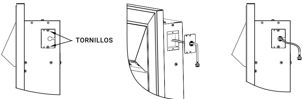
**1.2** Marque cuidadosamente las posiciones de los tornillos de fijación como se describe a continuación. Utilice dos tornillos ST4\*12 y deje unos 4 mm entre la pared/superficie y la cabeza del tornillo.
