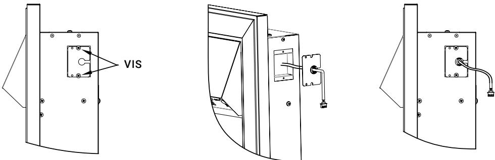
**1.2** Tracez soigneusement les positions des vis de fixation comme indiqué ci-dessous. Utilisez deux vis ST4\*12 et laissez environ 4 mm entre le mur/surface et la tête de vis.
