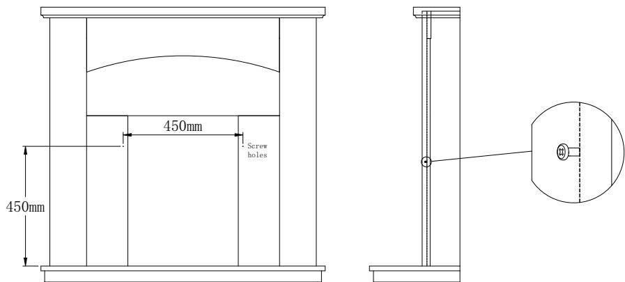
**1.3** Montaje de la unidad de chimenea eléctrica en la repisa de la chimenea.
