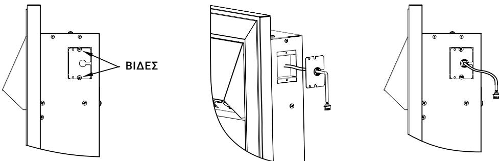
**1.2** Σημειώστε προσεκτικά τη θέση των βιδών στερέωσης όπως περιγράφεται παρακάτω. Χρησιμοποιήστε δύο βίδες ST4\*12 και αφήστε περίπου 4 mm κενό μεταξύ του τοίχου/επιφάνειας και της κεφαλής της βίδας.
