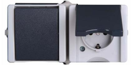
Aufputz-Feuchtraum Aus-/Wechselschalter-Steckdosenkombination im Design proAQA und der Farbe grau in waagrechtter Ausführung ohne erhöhtem Berührungsschutz, Nennspannung liegt bei 250V~. Schaltvermögendes Schalters liegt bei 10AX und der Nennstrom der Steckdose liegt bei 16A. Schutzart IP44
