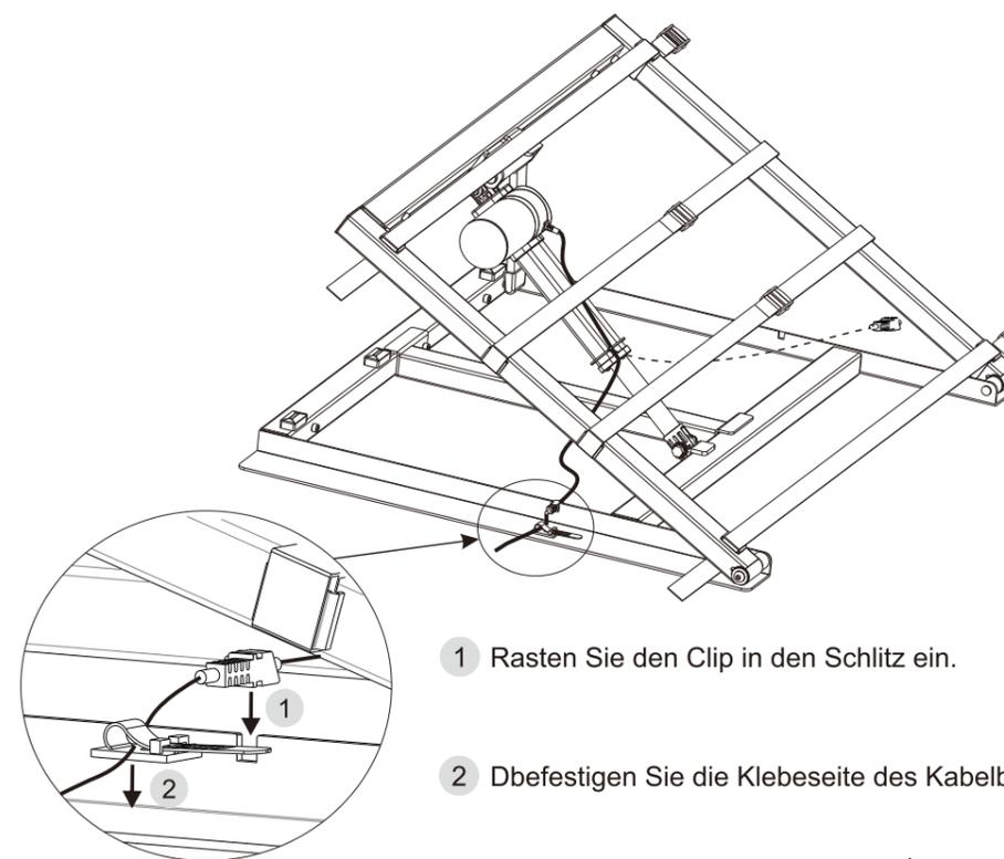
3 Schließen Sie das Eingangsstromkabel (Stellantrieb) an den Adapter bzw. die Fernsteuerung an.
