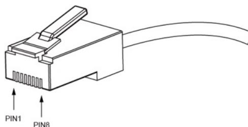
Das Kabel wird verwendet, um den Konsolenanschluss des Switches mit einem externen Monitoring-Gerät zu verbinden. An einem Ende des Kabels befindet sich der 8-Pin-Anschluss, am anderen Ende befindet sich ein Stecker mit 25 (DB25 oder 9 (DB9) Löchern. Der 8-Pin-Anschluss wird am Switch befestigt, der DB25- oder DB9-Stecker kann je nach Anforderungen an den Serienport des Monitoring-Gerätes angeschlossen werden. Das interne Verbindungsschema ist wie folgt:
