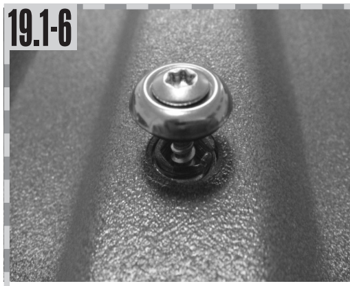
19.1-6 ... und mit demselben Torx 20-Bit einschrauben...
