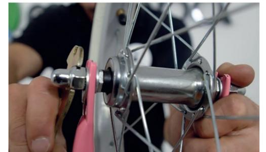
Es ist darauf zu achten, dass die Nase der Sicherungsscheibe im dafür vorgesehenen Loch der Gabel eingreift. Achten Sie auf die Laufrichtung (Rotation →). Verschrauben Sie die beiden Hutmutter. Verwenden Sie hierfür das mitgelieferte Multitool (10).
