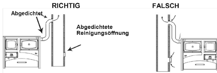
(Abb. 4) Abdichtung von Herdofen, Ofenrohr und Rauchabzug/Schornstein
