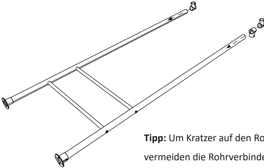
**Tipp:** Um Kratzer auf den Rohren zu vermeiden die Rohrverbinder vorsichtig verschieben und nur an den vorgesehen Stellen festziehen
