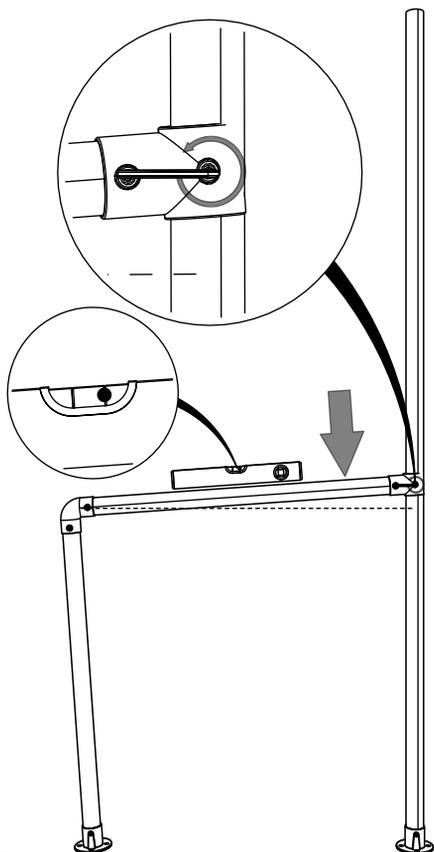
Führe die Stützbarren in die vormontierten T-Rohrverbinder der Außenrohre und löse die zwei Schrauben im Rohrverbinder. Bringe die Stützbarren unter Spannung. Drücke sie dafür nach unten.
