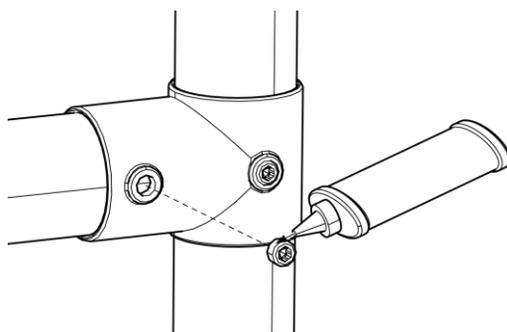
Auf jede Madenschraube muss vor dem endgültigen Festziehen Loctide aufgetragen werden
