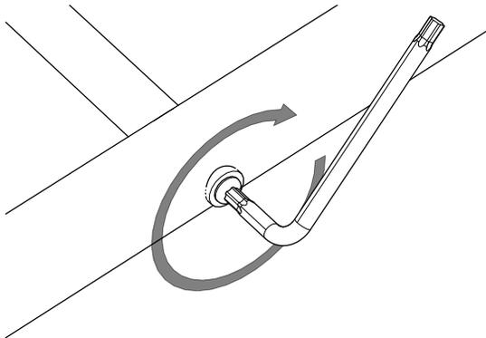
Die Schrauben der Sprossen werden so fest angezogen, dass die Sprossen nicht mehr wackeln und sich nicht mehr drehen können
