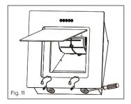
Defektes LED-Modul behutsam lösen und ersetzen.
