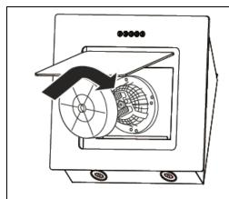
Neuen Aktivkohlefilter auf der Oberseite des Motors anbringen. Den Filter auf die Plastiknasen drücken und drehen bis er einrastet (Bajonettverschluss).
