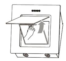
• Metallfilter in umgekehrter Reihenfolge wieder richtig einsetzen.
