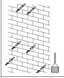
Die Dübel in die Bohrlöcher von Ø 8 mm Durchmesser einsetzen und fixieren.
