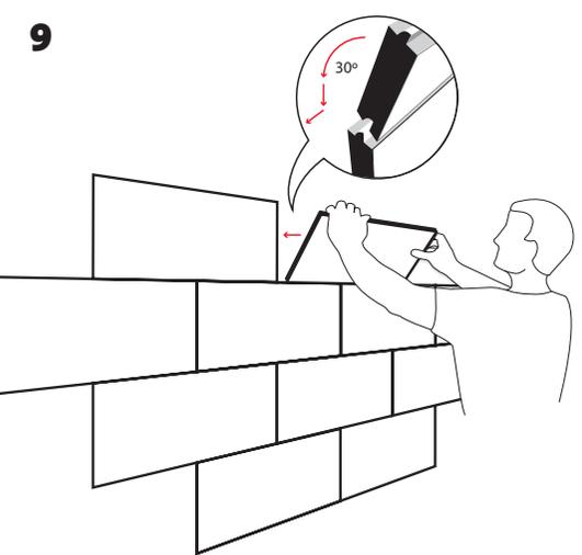
**8.** Para ajustar en los extremos de la pared realizar los siguientes pasos / To adjust at the edges of the walls, use the following procedure / Zum Anpassen an den Wandecken folgendermaßen vorgehen:
