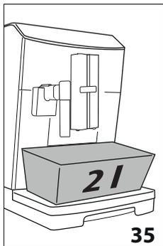
Unter dem Heißwasserlauf (C6) und dem Kaffeerauslauf (A14) einen leeren Behälter mit einem Mindestfassungsvermögen von 2 l positionieren (Abb. 35); drücken;
