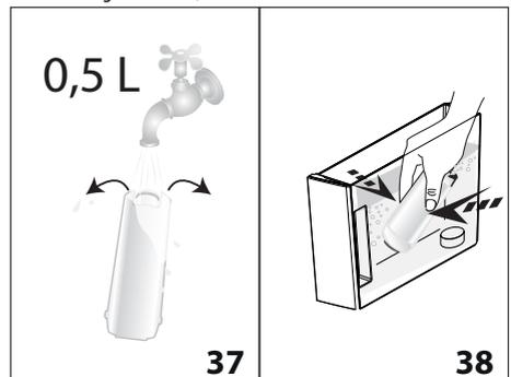
4. Den Tank (A18) aus der Kaffeemaschine nehmen und mit Wasser füllen;
