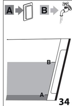
7. "Entkalker und Wasser in den Tank geben": Den Entkalker bis zum auf der Innenseite des Tanks aufgedruckten Füllstand A (entspricht einer 100ml Packung) in den Wassertank geben; dann bis zum Füllstand B (Abb. 34) mit Wasser (11) auffüllen; den
