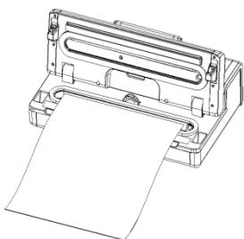
Verzeker u ervan dat het open eind van het zakje zich binnen de vacuümkamer bevindt. Het zakje mag niet over de aanzuigaansluiting worden gelegd.
