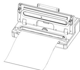
Legen Sie ein Ende des Beutels über den Schweißbalken aber nicht in die Vakuumkammer.
