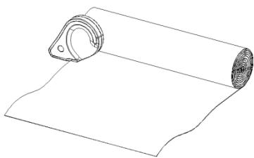
Desenrolle la lámina hasta la longitud deseada y corte una bolsa del rollo mediante la unidad de corte.
