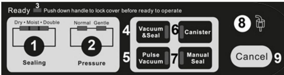
**1 Tiempo de sellado (Sealing):** Hay tres ajustes para seleccionar el tiempo de sellado "seco" (dry), para un producto al vacío seco o sin líquido, con intervalo de sellado corto. "húmedo" (moist), para un producto al vacío húmedo o con líquido, con intervalo de sellado normal.
