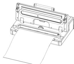
Coloque un extremo de la bolsa sobre la barra de sellado, pero no en la cámara de sellado.
