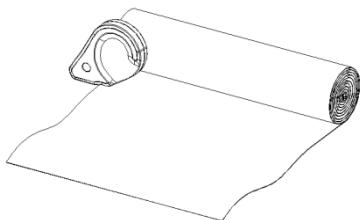
Mettere un'estremità del sacchetto sopra la barra di saldatura, ma non nella camera del vuoto.
