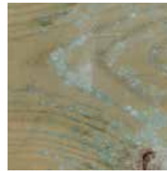
Retention of sterilization products Retención de productos de esterilización Retention de produits détuve Rückstände von Sterilisationsprodukten Ritenzione di prodotti per la sterilizzazione Vasthouden van impregneringsmiddelen Retenção de produtos de esterilização
