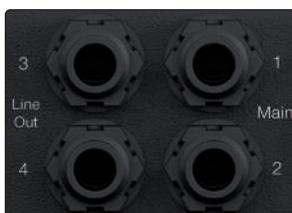
**Monitorausgänge** – Nutzen Sie die zwei 6,35 mm TRS-Klinkenbuchsen (Main) zum Anschluss Ihrer Haupt-Studiomonitore. Die Monitorausgänge sind galvanisch gekoppelt und können zur Ausgabe von Steuerspannungen genutzt werden.
