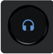
**Kopfhörertaste** – Drücken Sie die Kopfhörertaste, um mit dem Drehregler die Kopfhörerlautstärke zu steuern (der Drehregler leuchtet grün). Um wieder zur Lautsprechersteuerung zu wechseln, drücken Sie einfach die Kopfhörertaste erneut oder drücken Sie die Main-Taste.
