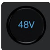
**Phantomspannung** – Drücken Sie die Taste 48V, um die Phantomspannung ein- oder auszuschalten: Die Taste leuchtet rot, wenn die Funktion aktiv ist, und blau, wenn sie inaktiv ist.
