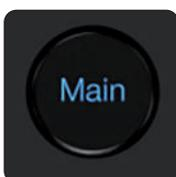
**Lautsprechersteuerung („Main“-Taste)** – Drücken Sie die Main-Taste, um mit dem Drehregler die Gesamtlautstärke zu steuern. Dies ist der Standardmodus für den Endlosregler. Alle anderen Modi, mit Ausnahme des Kopfhörermodus, wechseln nach einer gewissen Zeit wieder in diesen Modus zurück.
