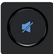
**Mute-/Dim-Taste** – In der Voreinstellung schaltet die Mute-Taste die Hauptausgänge stumm. Optional lässt sich die Taste in Universal Control als Dim-Taste konfigurieren. Das Maß der Dämpfung beträgt in der Voreinstellung -10 dB und kann ebenfalls in den Einstellungen des Universal-Control-Mixers konfiguriert werden.
