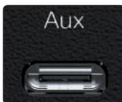
**AUX-Stromanschluss (USB-C)** – Falls der USB-C-Port, an dem das Interface angeschlossen ist, nicht genügend Strom liefert, wird eine zusätzliche (optional erhältliche) USB-C-Stromversorgung benötigt.
