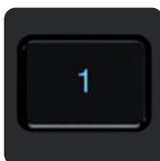
**Kanalauswahl-tasten** – Drücken Sie diese Taste im gewünschten Kanal, um den Gain-Pegel eines bestimmten Kanals zu bearbeiten. Um den Channel-Edit-Modus zu verlassen, drücken Sie die Kanalauswahl-taste (erneut) oder die Main- oder die Kopfhörer-Taste.
