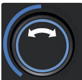
**Leuchtmarkierung der Reglerposition** – Der äußere Leuchtring des Drehreglers zeigt die relative Reglerposition in der Farbe des jeweiligen Modus an. Es wird die relative Reglerposition für den Gesamtpegel, das Gain oder die Kopfhörerlautstärke dargestellt.
