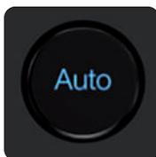
**Auto-Gain-Taste** – Wenn ein Kanal ausgewählt ist, können Sie die Auto-Gain-Taste drücken, um den Gain-Pegel des ausgewählten Kanals automatisch anzupassen. **(Weitere Informationen zur Auto-Gain-Funktion finden Sie in Abschnitt 5.3.)** Die Auto-Gain-Funktion kann nur mit Mikrofon- und Gitarreneingängen (nicht mit Line-Eingängen) genutzt werden.
