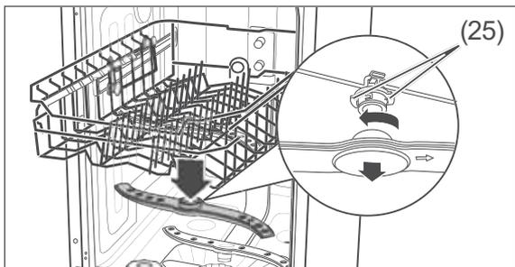
3. Der obere Sprüharm ist mit einem Bajonett-Verschluss befestigt. Zum Abnehmen des Sprüharms halten Sie die beiden gezackten Bajonettgriffe (25) fest und drehen Sie den Sprüharm im Uhrzeigersinn ab.
