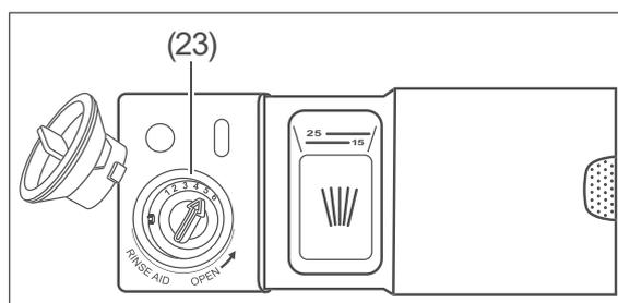
1. Drehen Sie den Deckel der Klarspülmitelkammer (23) eine Viertelumdrehung gegen den Uhrzeigersinn und nehmen Sie ihn heraus.
