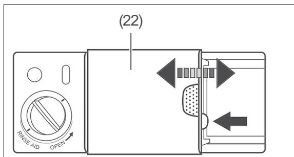
1. Schieben Sie den blauen Verschluss der Kammer für Geschirrspülmittel/Multitabs (22) zur Seite. Der Deckel fährt zur Seite und die Kammer wird sichtbar.
