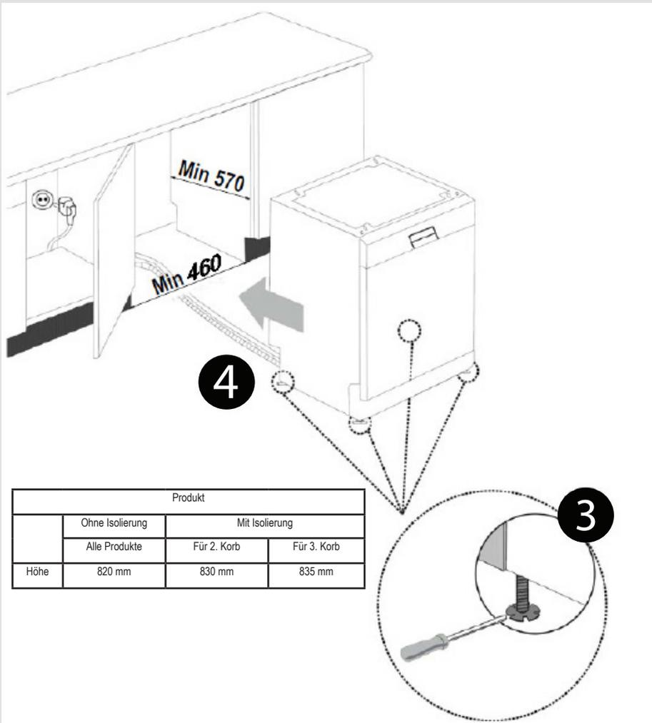
**Warnung:** Nachdem die Arbeitsplatte entfernt wurde, muss die Maschine in einem abgeschlossenen Platz mit den in der Abbildung gezeigten Abmessungen aufgestellt werden.
