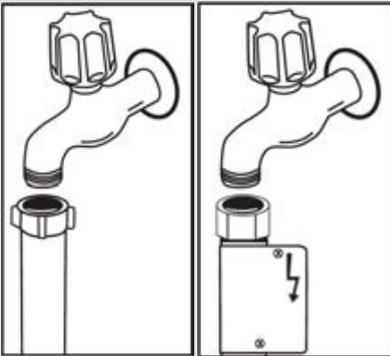
**HINWEIS:** Einige Modelle sind mit einer Aquastop-Einrichtung ausgerüstet. Für den Fall der Verwendung des Aquastop ist eine gefährliche Spannung vorhanden. Schneiden Sie die Aquastop-Einrichtung nicht ab. Sie darf nicht geknickt oder verdreht werden.
