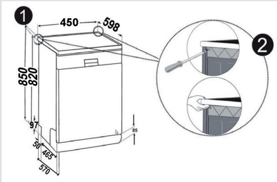
**Achtung:**Die Oberfläche, auf der Sie Ihre Spülmaschine nach Entfernung der Arbeitsplatte aufstellen möchten, muss so stabil sein, dass sie in der Waage steht. Zur Entfernung der Arbeitsplatte müssen Sie die Schrauben, die die Arbeitsplatte hinten am Gerät fest halten, lösen und dann die Frontplatte 1 cm von der Vorderseite nach hinten drücken und sie anheben.
