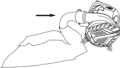
3. Inserte el extremo del tubo de conexión en la carcasa del cabezal de transmisión y luego deslícelo hacia el dispositivo. Vuelva a apretar los tornillos.
