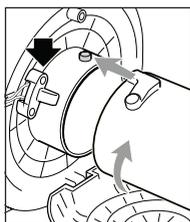
6. Laat het ventilatordeksel zakken en breng de bovenste aanzuigbuis aan. Zorg ervoor dat de contactplaat uitgelijnd is met de veiligheidsschakelaar op de kop. Duw de buis zo ver mogelijk naar binnen en draai hem dan tegen de klok in.
