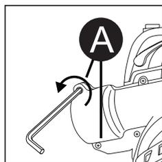
1. Rimuovere le viti (A) in cima al dispositivo di azionamento con la chiave a brugola in dotazione e conservarle in un luogo sicuro.
