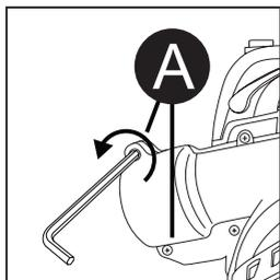
2. À l'aide de la clé Allen fournie, dévissez les vis (A) de la tête d'entraînement et rangez-les dans un endroit sûr.
