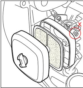
Lassen Sie das Gerät im Leerlauf laufen. Justieren Sie die Leerlaufgeschwindigkeit, damit die Maschine läuft, ohne zu stoppen (Leerlaufgeschwindigkeit zu niedrig).
