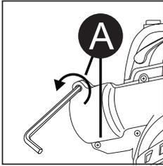
1. Entfernen Sie die Schrauben (A) am Antriebskopf mit dem mitgelieferten Inbusschlüssel und bewahren Sie sie an einem sicheren Ort auf.
