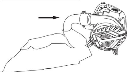
3. Insérez l'extrémité du tube de raccordement dans le boîtier de la tête d'entraînement, puis poussez-le vers la machine. Resserrez les vis.
