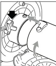
6. Baje la tapa del soplador e inserte el tubo de succión superior. Asegúrese de que la placa de contacto esté alineada con el interruptor de seguridad del cabezal. Empuje el tubo hacia adentro hasta que se detenga, luego gírelo en sentido antihorario.
