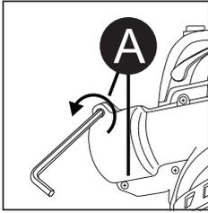
1. Retire los tornillos (A) del cabezal de transmisión con la llave Allen suministrada y guárdelos en un lugar seguro.
