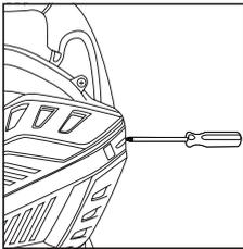
4. Lösen Sie die Schraube der Lüfterabdeckung gegen den Uhrzeigersinn, die Schraube sollte an der Abdeckung bleiben.
