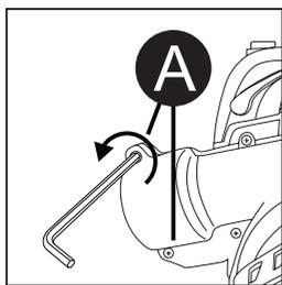
2. Utilizzare la chiave a brugola in dotazione per svitare le viti (A) in cima al dispositivo di azionamento e conservarle in un luogo sicuro.
