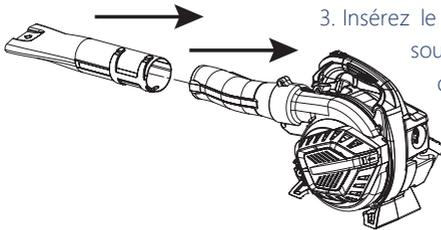
3. Insérez le tuyau de soufflage inférieur dans le tuyau de soufflage supérieur et fixez-le avec les 2 vis. Pour le démontage, procédez dans l'ordre inverse.
