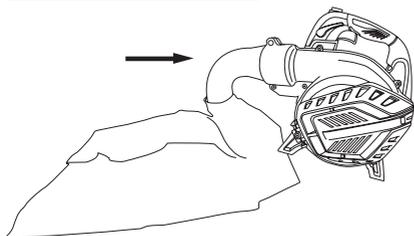
3. Inserire l'estremità del tubo di collegamento nell'alloggiamento in cima al dispositivo di azionamento e quindi farlo scorrere verso la macchina. Serrare le viti.
