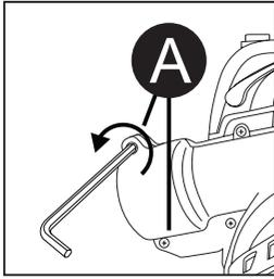
2. Utilice la llave Allen suministrada para destornillar los tornillos (A) del cabezal de transmisión y guárdelos en un lugar seguro.
