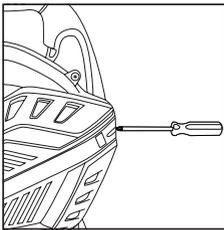
4. Afloje el tornillo de la cubierta del soplador en sentido antihorario, el tornillo debe permanecer en la cubierta.
