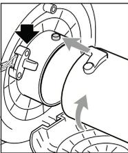
6. Senken Sie die Lüfterabdeckung ab und setzen Sie das obere Saugrohr ein. Achten Sie dabei darauf, dass das Kontaktblech mit dem Sicherheitsschalter am Kopf ausgerichtet ist. Schieben Sie das Rohr bis zum Anschlag ein und drehen Sie es dann gegen den Uhrzeigersinn.
