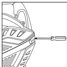
4. Draai de schroef van het ventilatordeksel tegen de klok in los, de schroef moet op het deksel blijven zitten.
