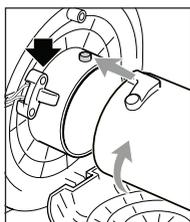
6. Abaissez le couvercle du ventilateur et insérez le tube d'aspiration supérieur. Assurez-vous que la plaque de contact est alignée avec l'interrupteur de sécurité sur la tête. Enfoncez le tube jusqu'à la butée, puis tournez-le dans le sens inverse des aiguilles d'une montre.
