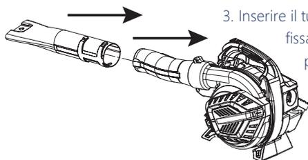
3. Inserire il tubo dell'aspiratore inferiore nel tubo superiore e fissarlo con le 2 viti. Per smontare il dispositivo procedere in ordine inverso.
