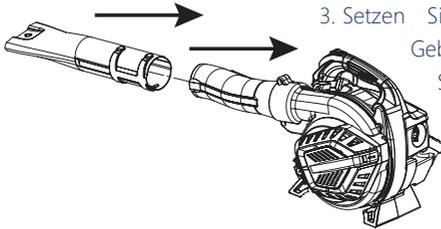
3. Setzen Sie das untere Gebläserohr in das obere Gebläserohr ein und sichern Sie es mit den 2 Schrauben. Zur Demontage gehen Sie in umgekehrter Reihenfolge vor.
