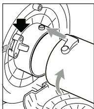
6. Abbassare il coperchio della ventola e inserire il tubo di aspirazione superiore. Assicurarsi che la piastra di contatto sia allineata con l'interruttore di sicurezza sulla testa. Spingere il tubo fino all'arresto, quindi ruotarlo in senso antiorario.
