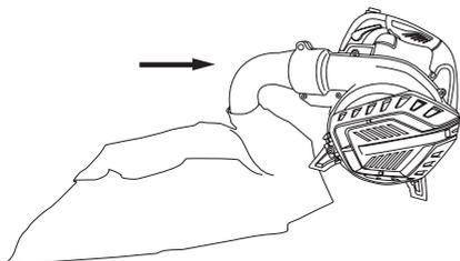
3. Steek het uiteinde van de verbindingbuis in de behuizing van de aandrijfkop en duw deze vervolgens in de richting van de machine. Draai de schroeven weer vast.
