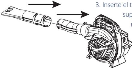
3. Inserte el tubo del soplador inferior en el tubo del soplador superior y fjelo con los 2 tornillos. Para desmontar, realice los pasos en orden inverso.
