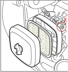
Deje el dispositivo inactivo. Ajuste la velocidad del ralentí para que la máquina funcione sin detenerse (velocidad de ralentí demasiado baja).
