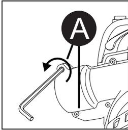
2. Schrauben Sie mit dem mitgelieferten Inbusschlüssel die Schrauben (A) am Antriebskopf ab und bewahren Sie sie an einem sicheren Ort auf.
