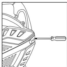
4. Desserrez la vis du couvercle du ventilateur dans le sens inverse des aiguilles d'une montre, la vis doit rester sur le couvercle.
