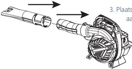
3. Plaats de onderste aanjagerbuis in de bovenste aanjagerbuis en zet hem vast met de 2 schroeven. Ga voor de demontage in omgekeerde volgorde te werk.
