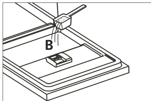
3. Geben Sie die restlichen 1/5 des Geschirrspülmittels auf die Innenseite der Gerätetür **B**. Diese Menge verwendet das Gerät während des Vorspülprogramms.
