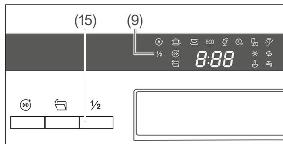
Wählen Sie die Option „Halbe Beladung“, wenn Sie das Gerät mit weniger als 6 Gedecken betreiben möchten. Der Wasser- und Stromverbrauch wird durch diese Zusatzoption reduziert.
