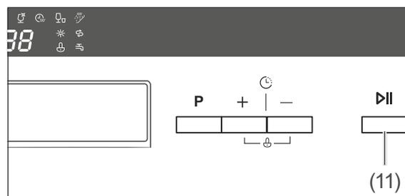
1. Drücken Sie die Taste >|| (11), um das Spülprogramm zu unterbrechen. Die LED neben dem Programmsymbol leuchtet nun dauerhaft.
