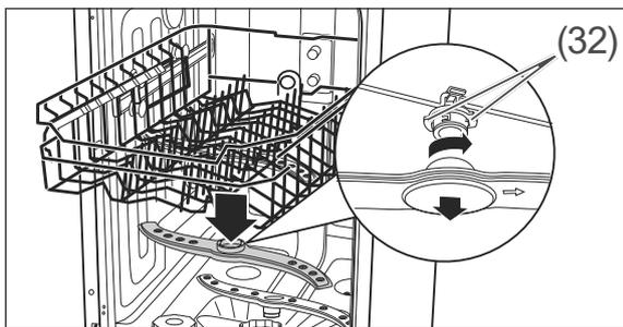
3. Der obere Sprüharm ist mit einem Bajonett-Verschluss befestigt. Zum Abnehmen des Sprüharms halten Sie die beiden gezackten Bajonettgriffe (32) fest und drehen Sie den Sprüharm im Uhrzeigersinn ab.
