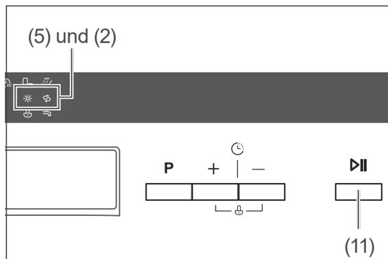
2. Halten Sie die Taste **P** (13) so lange gedrückt, bis die Anzeigen \* (5) und S (2) abwechselnd blinken.
