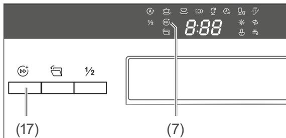
Mit dieser Option lässt sich das Reinigungsprogramm beschleunigen.
