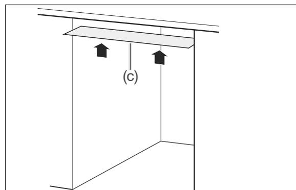
3. Kleben Sie die beiliegende Schutzfolie für Kondenswasser (c) auf die Unterseite der Arbeitsplatte. So vermeiden Sie Schäden an der Arbeitsplatte aufgrund heißer
